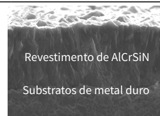
Fotografia do revestimento obtida por MEV (Microscopia eletrônica de varredura)
