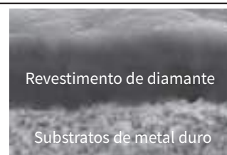
Fotografia do revestimento obtida por MEV (Microscopia eletrônica de varredura)
