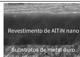
Fotografia do revestimento obtida por MEV (Microscopia eletrônica de varredura)
